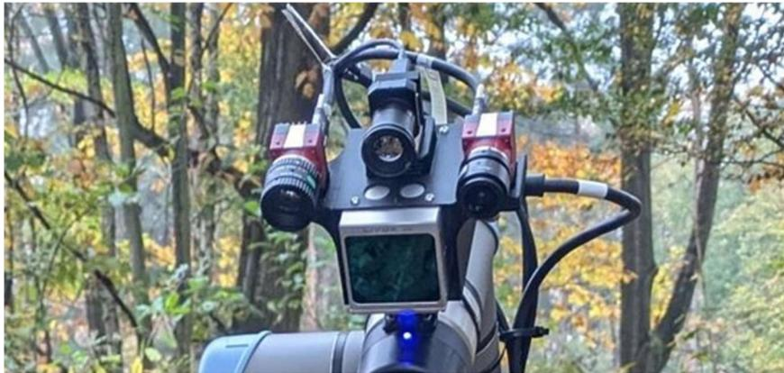
Figure 2. Exemple de système de capture de données multi-spectrales (RGB, SWIR, LWIR) et LiDAR à des fins de détection d'objet
